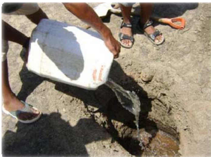
Figura 7: Momento da realização dos testes de absorção
