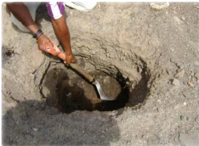
Figura 6: Momento da escavação para conhecer o perfil do terreno. Detalhe do perfil do terreno. Os solos apresentam uma variedade diversa, são geralmente exíguos, pouco profundos, bastante pedregosos e originados a partir de rochas vulcânicas.
